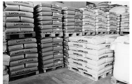
Fig. 6: deposito di sacchi su palette di legno. Per non pregiudicare la qualità del prodotto, l'altezza della catasta deve limitarsi a due palette.
