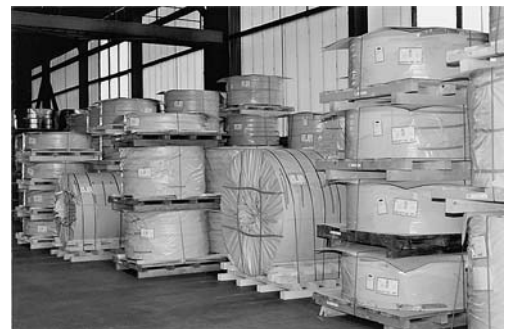
Fig. 5: le merci di forma cilindrica possono essere accatastate solo verticalmente o su palette speciali.
