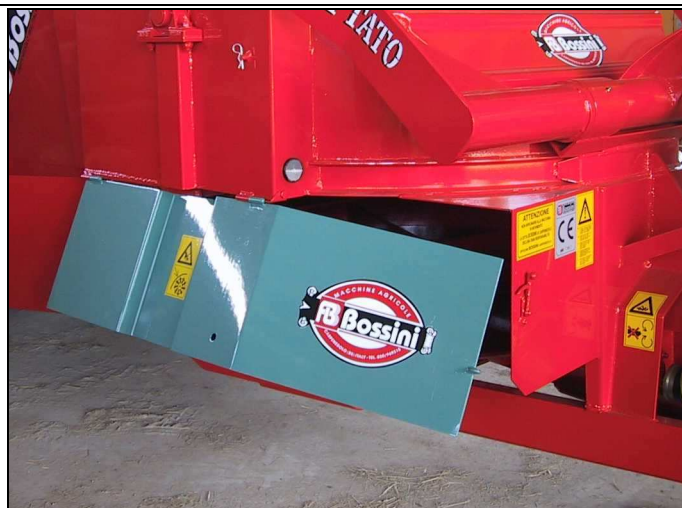
ROTEZIONE DELL'ORGANO SPANDITORE. RIPARO IN POSIZIONE DI CHIUSO QUANDO LA MACCHINA NON E' UTILIZZATA E IN POSIZIONE DI APERTO DURANTE LO SPANDIMENTO
