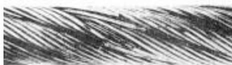
Fili rotti in un trefolo unitamente ad una lieve usura, in una fune ad avvolgimento parallelo. Tenere la fune sotto controllo, togliere i fili spezzati in modo che le estremità siano a raso del **profilo esterno**.
