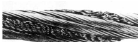
Fuoriuscita dell'anima metallica dovuta ad una distorsione derivante da un carico improvviso.
